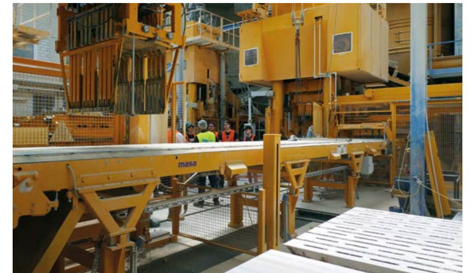
Kalksandsteinwerk der Fa. Bayer Baustoffwerke bei Kernen-Stetten, Erläuterung des Produktionsablaufs der Herstellung von Kalksandstein-Rohblöcken aus keuperzeitlichen Quarzsanden durch den Geschäftsführer Jörg Bayer
