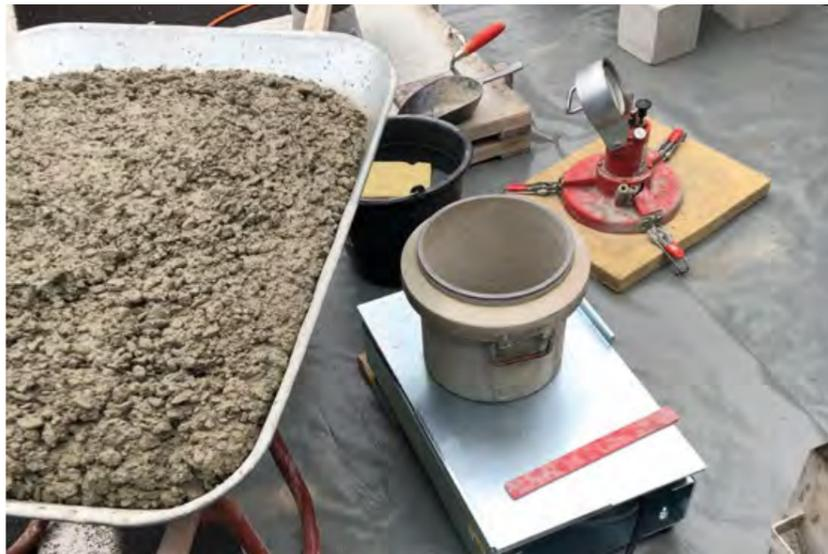
Geprüfte Qualität: Prüfung des Luftporengehaltes im Frischbeton
