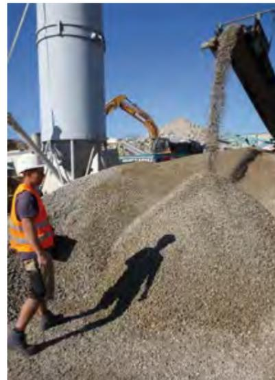
Beim Baustoffrecycling wird in der Vorsiebanlage (L.) mit hohem Aufwand der schadstoffhaltige Feinanteil des Bauschutts abgetrennt und beseitigt. Aus der Grobfraction (M.) werden durch Brechen, Sieben und Klassieren verschiedene Lieferkörnungen hergestellt (r.). Falls diese für den EU-Säulenversuch wieder kleingemahlen werden müssen, sind Schadstoffüberschätzungen und Grenzwertüberschreitungen zu befürchten.
