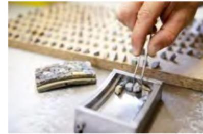
Bestimmung des Polierwertes (PSV) gemäß EN 1097-8 bzw. die Beständigkeit von Gesteinskörnungen gegen die Polierwirkung von Fahrzeugreifen: Probekörperherstellung (links), Poliervorgang – zwischen Straßenrad und Vollgummirad wird Wasser und Poliermittel zugeführt (Mitte), Ermittlung des Polierwertes mit Griffigkeitsmessgerät (rechts)
