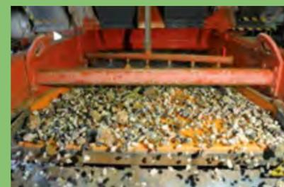
Arbeitsabläufe in der Grube Clara: Abwurf des Trommelfilters zur Entwässerung der Flussspat-Flotationskonzentrate, Geschäftsführer Robert Mauerlechner überprüft die Produktion, Helligkeitsmessung an einer Mahlspatprobe im Versandlabor, Big Bags mit Fluss- und Schwerspat, Produkte, die Fluss- oder Schwerspat enthalten (v.l.o.n.r.u.)
