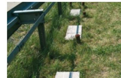
In der Nähe der Waschbetonerprobungsstrecke wurden Probekörper ausgelagert zur zerstörungsfreien Überprüfung der Alkaliempfindlichkeit bei realen Bedingungen.
