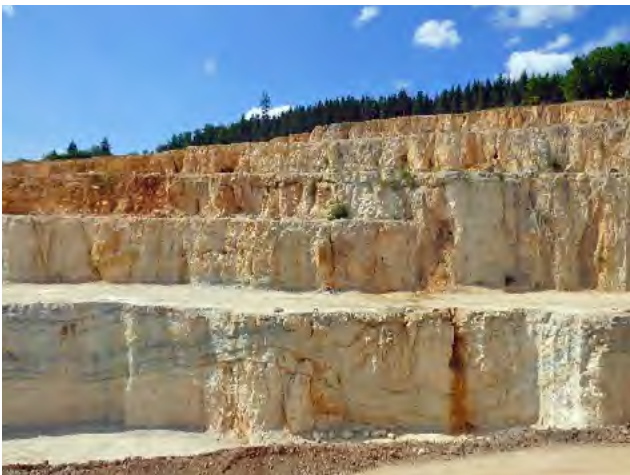
Abbildung 10: Kalksteinbruch im Unteren Massenkalk mit großer nutzbarer Mächtigkeit
