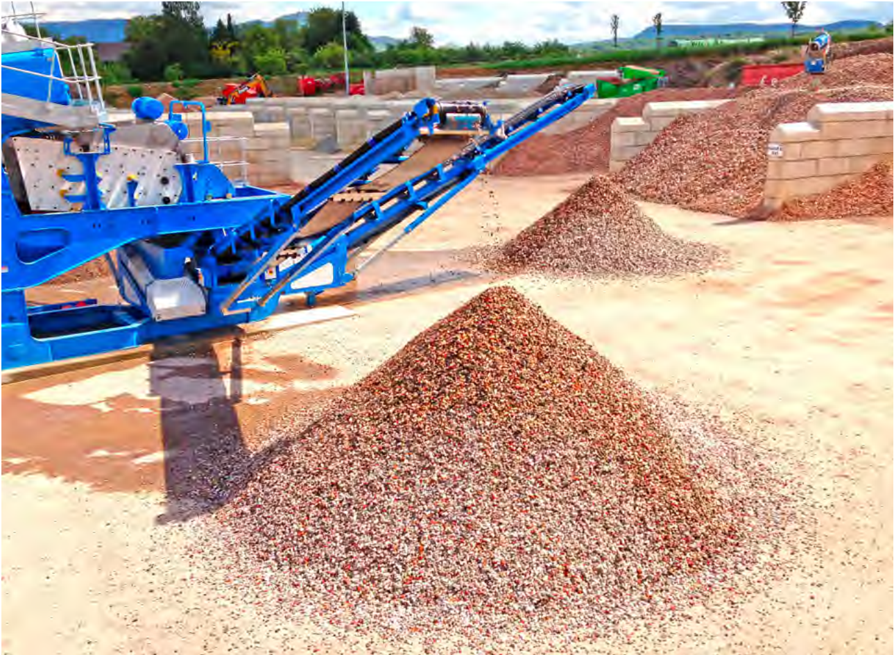
Abbildung 6: Recycling – Output-Material: sortenreines Splitt-, Kies-, Schottermaterial
