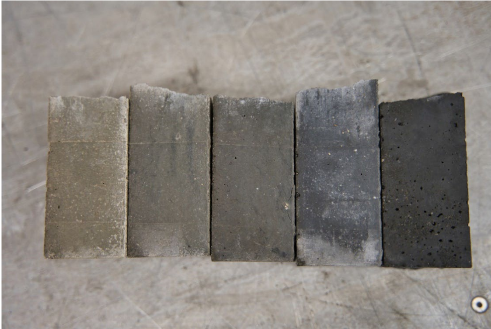
Gebäude als Kohlenstoffsenken: ecoLocked entwickelt klimafreundlichen Beton durch die Integration von Zuschlägen aus Biokohlenstoff, einem CO 2 -negativen Material. | Foto: ecoLocked
